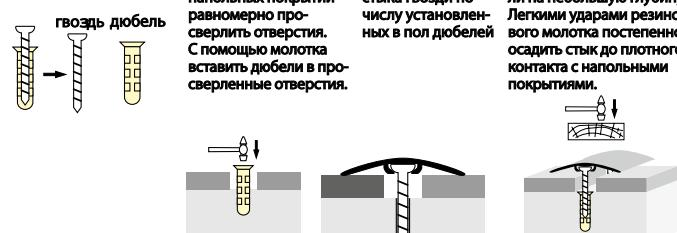
**Схема крепления углов со скрытым креплением**
