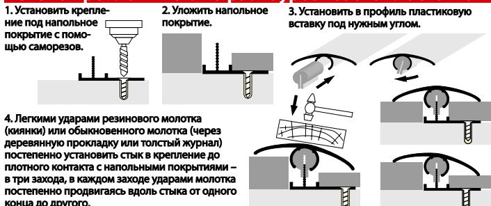
**Схема крепления стыка разноуровневого с дюбелем**
